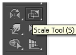
Scale Tool berfungsi untuk merubah ukuran objek. Jika objek sudah terefleksi, tekan Alt untuk membuat duplikat objek. Klik dua kali pada icon akan ada opsi-opsi untuk mengisi nilai pembesaran objek.
